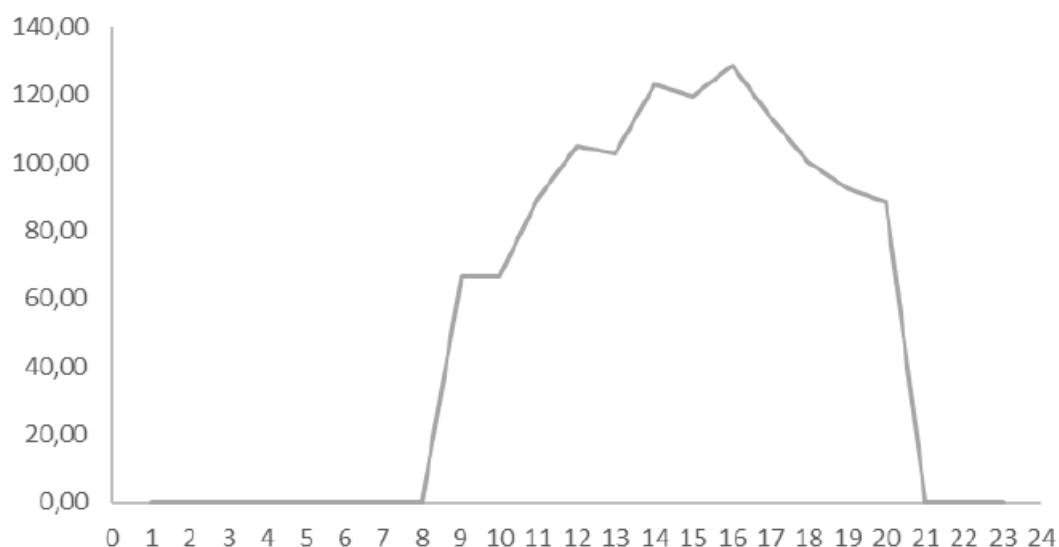
Διάγραμμα 6.5: Ωριαία Διακύμανση της κατανάλωσης ηλεκτρικής ενέργειας της Μέσης Τοπικής Ημέρας για την ψύξη του κολυμβητηρίου (KWh).
