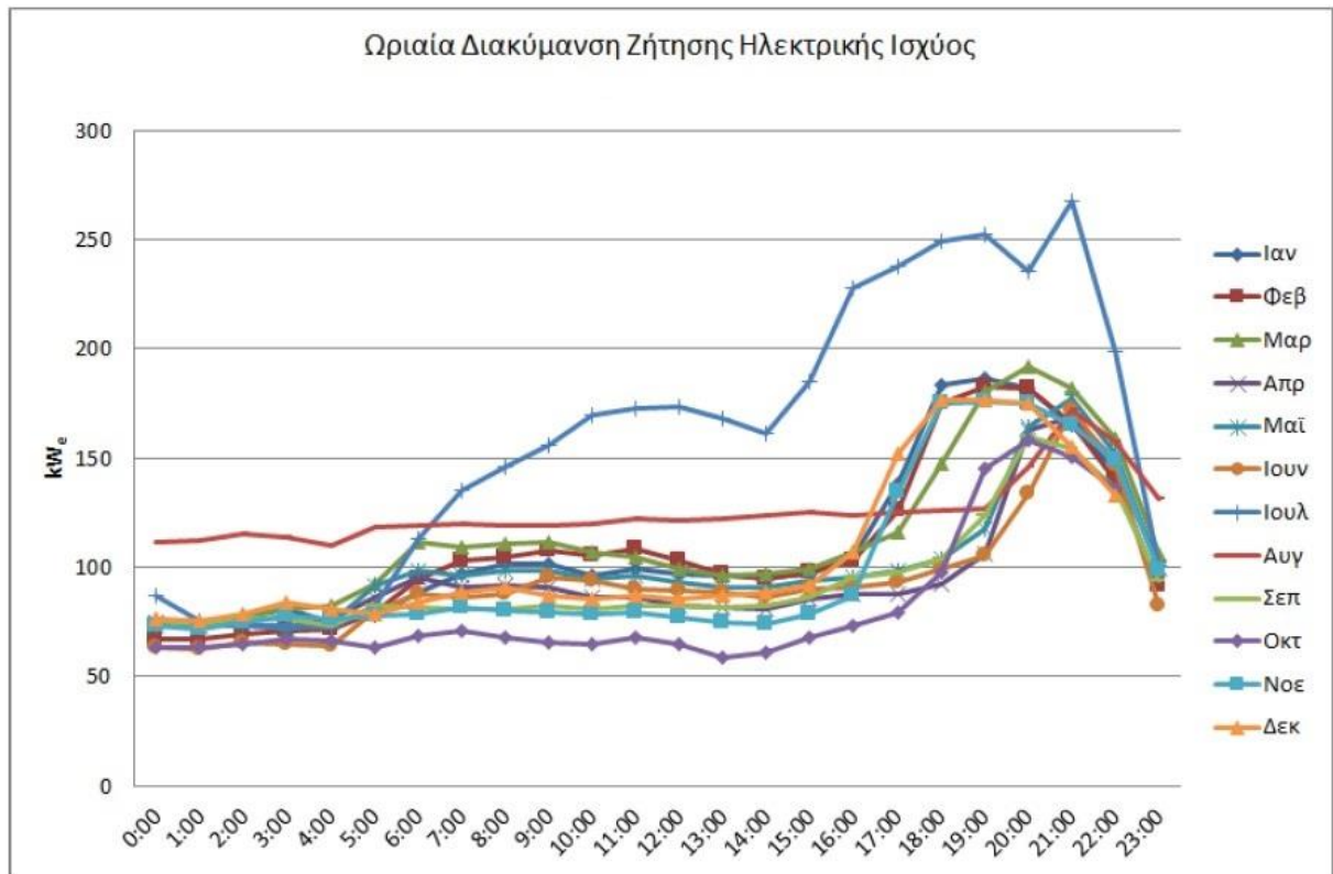
Διάγραμμα 2.6: Ωριαία διακύμανση της κατανάλωσης ηλεκτρικής ενέργειας για την τυπική ημέρα κάθε μήνα του έτους 2017 (έτος αναφοράς).
